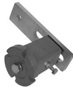
Die Spannelemente Typ **ME** und **MEP** sind aus Stahl, die Oberfläche ist Hammerschlageinbrennlackiert, der Hebelarm und die Schraube sind aus verzinktem Stahl. Bezeichnend für die Spannelemente ist dass die Länge des Hebelarmes individuell gewählt werden kann, somit auch die Kraft und Spannwinkele bestimmt werden kann.
